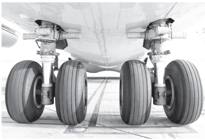
>> 飞机轮胎的载荷能力是车胎的10倍以上，抗形变率是车胎的3—4倍以上 科普中国网/供图
